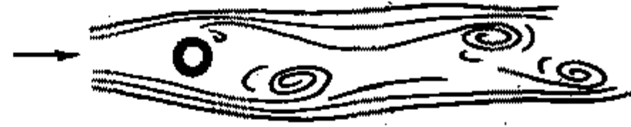
Hình 5.8. Đường xoáy Bernair-Carman ở mặt khuất gió khi dòng gió song song chảy vòng qua ống hình trụ
